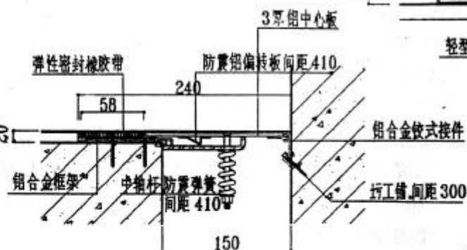
② 楼地面缝
